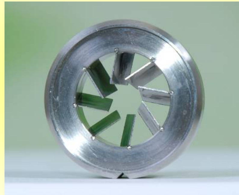
Links- und Rechtsdrallerzeuger nach EN 14154
