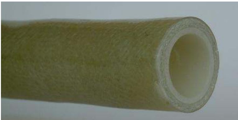
Bild: GFK Rohr bei der Messung von Flusssäure bei wechselnden Konzentrationen
