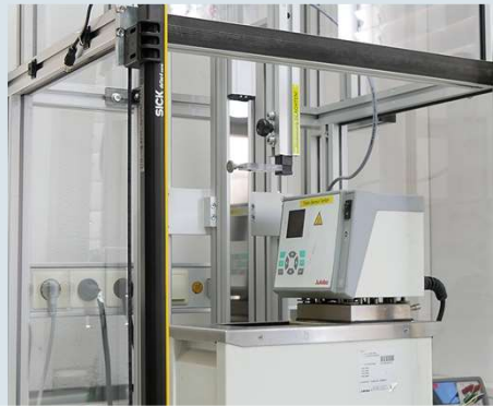
Messung von thermischen Ansprechzeiten
