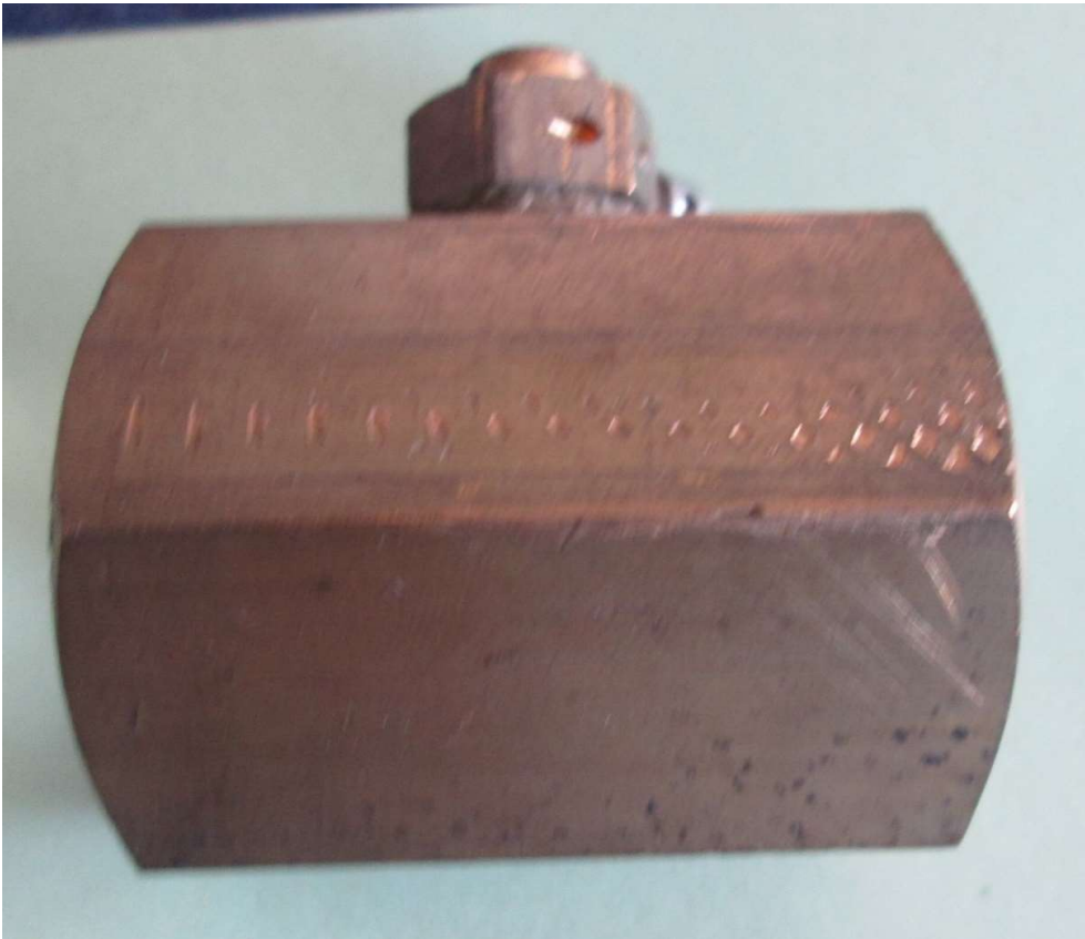
Adapter von M10 auf M10 mit Fühlerpassung für Fühler DS 27,5 mm (Kugelhahnadapter M10)
