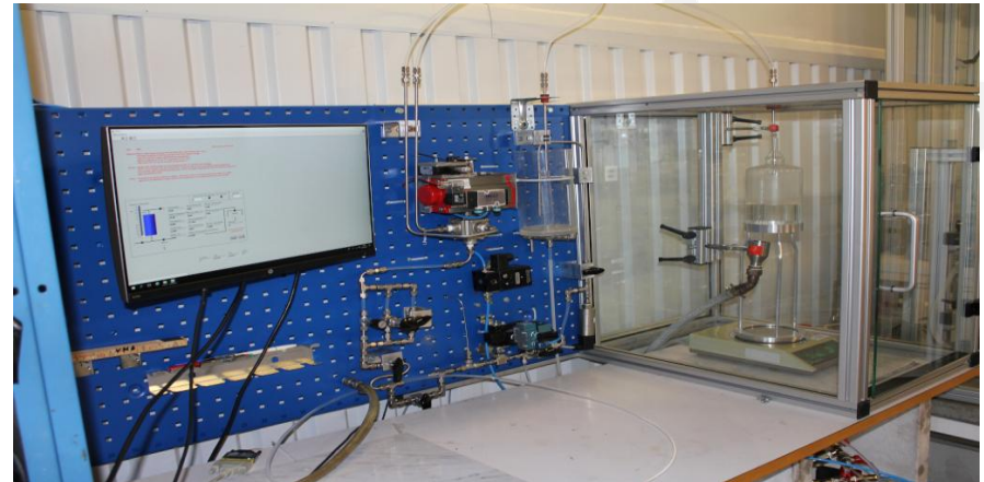
Die gravimetrische Mini-Durchflussmessanlage VM8 bei RISE
